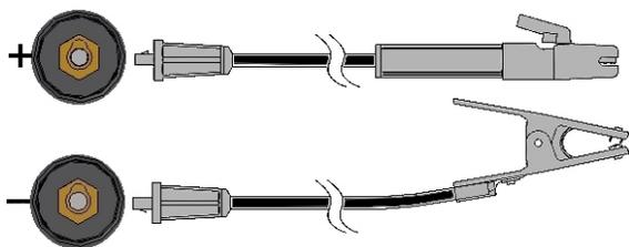
Ligue o cabo do eléctrodo ao terminal (+) e o grampo de trabalho ao terminal (-). Insira o conector com a chave alinhando com a chaveta e rodando aproximadamente ¼ de volta no sentido horário. Não aperte demasiadamente.
