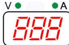
Se o LED A estiver ACESO, o visor apresenta a corrente de soldadura predefinida (A) antes da soldadura e a corrente de soldadura real durante a soldadura. Se o LED V estiver ACESO, o visor mostra a tensão (V) nos cabos de saída. Para mudar a visualização entre Corrente e Tensão:
