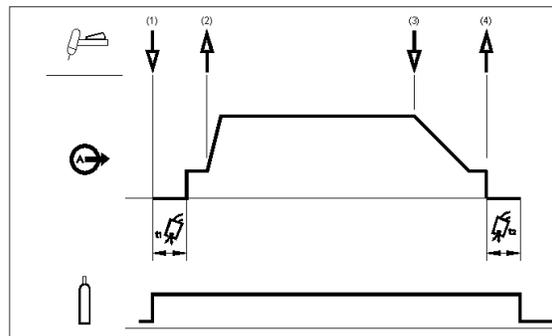
1. Prima e mantenha premido o gatilho do maçarico TIG para iniciar a sequência. A máquina abre a válvula de gás para iniciar o fluxo do gás de protecção. Decorrido o tempo de pré-fluxo, para purgar o ar do tubo do maçarico, a saída da máquina é LIGADA. Neste momento, o arco inicia-se de acordo com o modo de soldadura seleccionado. Depois de iniciado o arco, a corrente de saída é a corrente de início. Esta condição pode ser mantida pelo tempo necessário.
