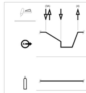
Quando se solta o gatilho do maçarico TIG, a saída aumenta de novo para a corrente de soldadura, como no passo 4, para prosseguir a soldadura. Quando a parte principal da soldadura estiver concluída, vá para o passo 3.
