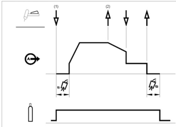
Como se viu acima, é possível premir e manter premido o gatilho do maçarico TIG uma segunda vez durante a descida para terminar a função descida e manter a corrente de saída na corrente de Cratera. Quando se solta o gatilho do maçarico TIG, a saída é desligada e o tempo de pós-fluxo inicia-se. Esta sequência de operações, 2-passos com reinício desactivado, é a configuração predefinida de fábrica.
