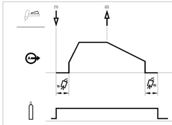
1. Prima e mantenha premido o gatilho do maçarico TIG para iniciar a sequência. A máquina abre a válvula de gás para iniciar o fluxo do gás de protecção. Decorrido o tempo de pré-fluxo, para purgar o ar do tubo do maçarico, a saída da máquina é LIGADA. Neste momento, o arco inicia-se de acordo com o modo de soldadura seleccionado. Uma vez iniciado o arco, a corrente de saída é aumentada a uma cadência controlada, ou tempo de subida, até se atingir a corrente de soldadura.
