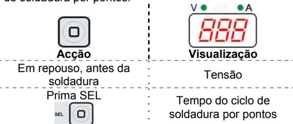
Neste ponto, o tempo do ciclo de soldadura por pontos pode ser ajustado rodando o botão da Corrente de saída. Definir o tempo do ciclo de soldadura por pontos para 0 desactiva a função de tempo fixo e o tempo de soldadura fica ligado ao gatilho do maçarico TIG.
