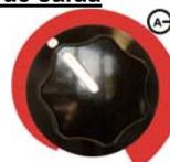
Potenciômetro usado para regular a corrente de saída durante a soldadura.
